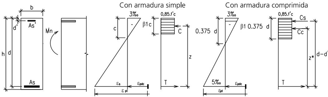
Para hormigón armado  $\epsilon_{pc}=0$ ,  $f_{ps}=f_y$
