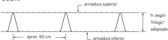
■ Una vez colocados los separadores **Acindar Trilogic®** en toda la superficie, se procederá a posicionar la armadura superior atándola o soldándola en 4 puntos por metro lineal, porque el alambre **Acindar T-500®** fabricado según norma IRAM-IAS U500-26, designación ATR 500, lo permite.
