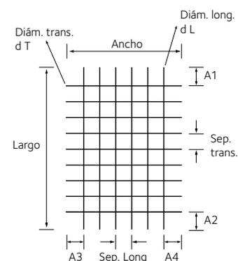
Salientes A1, A2, A3, A4: se definirán en función de las dimensiones del panel, diámetros y separaciones entre barras.
