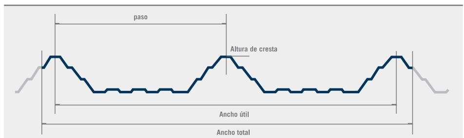
**Autoportante T900** Usado principalmente para la construcción de cubiertas con requerimientos exigentes de cargas. Este producto permite disminuir los apoyos y en ciertas ocasiones hasta eliminarlos, alcanzando considerables reducciones de la estructura de techo.
